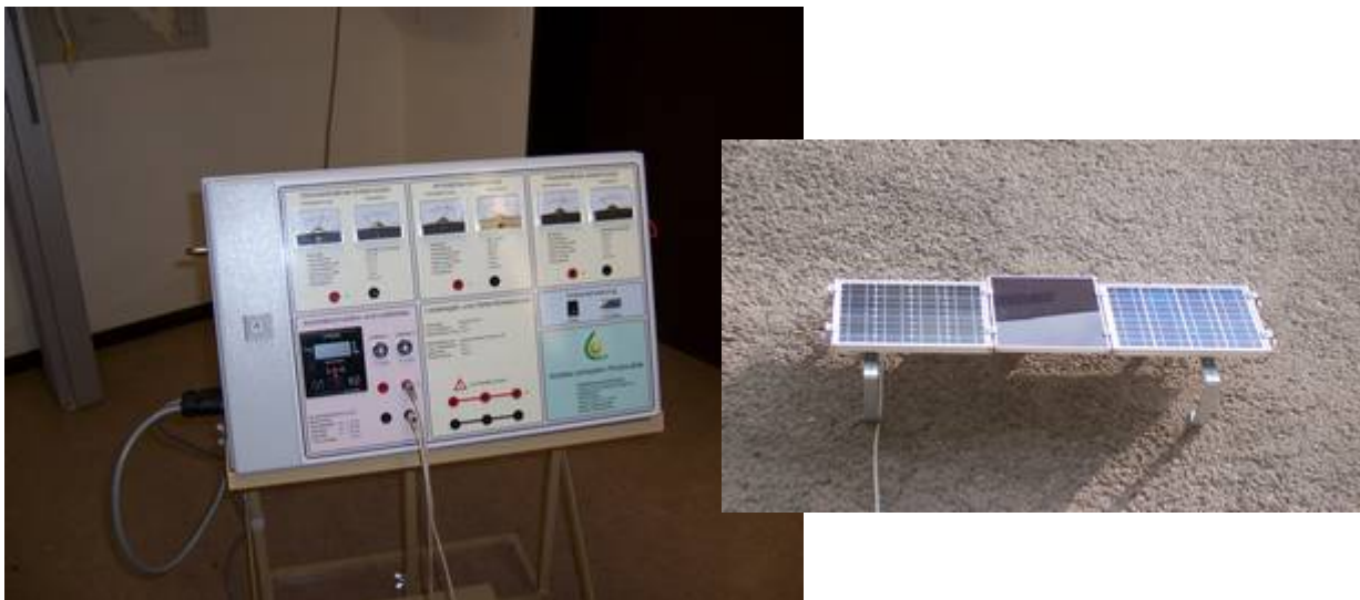
Abb. 2: Unsere Solaranlage, die eine Nennleistung von 27 W besitzt.
